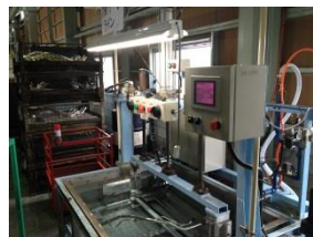
検圧機で検圧中
